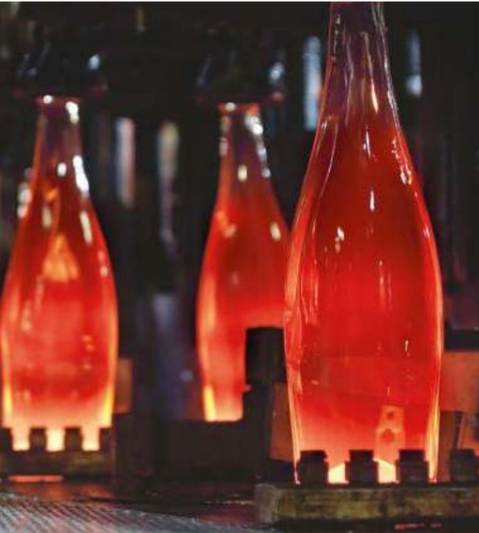
Die Flasche kommt fertig aus der Formungsmaschine, nun geht es zum Abkühlen in den Kühlöfen
