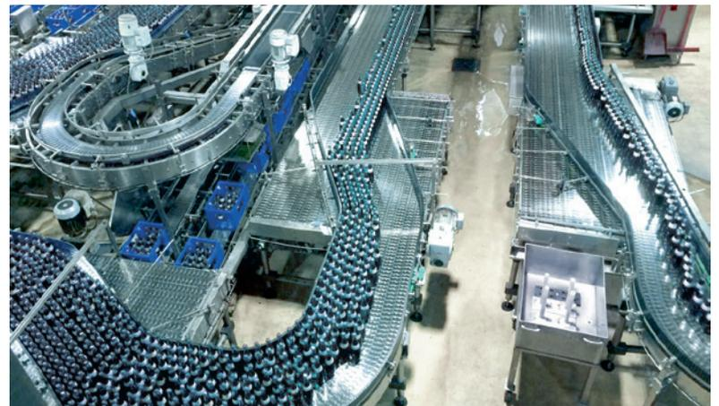
In unserer modernen Abfüllanlage findet das Mineralwasser den Weg in die Flasche. Doch die Anlage, die aus 27 Einzelmaschinen zusammengesetzt ist, leistet noch mehr. Ihr Aufgabenspektrum reicht vom Sortieren des Leerguts über das Entfernen der Verschlüsse, das Waschen der Kästen, das Reinigen und Prüfen der Glasflaschen bis zum Befüllen, Etikettieren und Abpacken. Woche für Woche befüllt sie Millionen von Glasflaschen.
